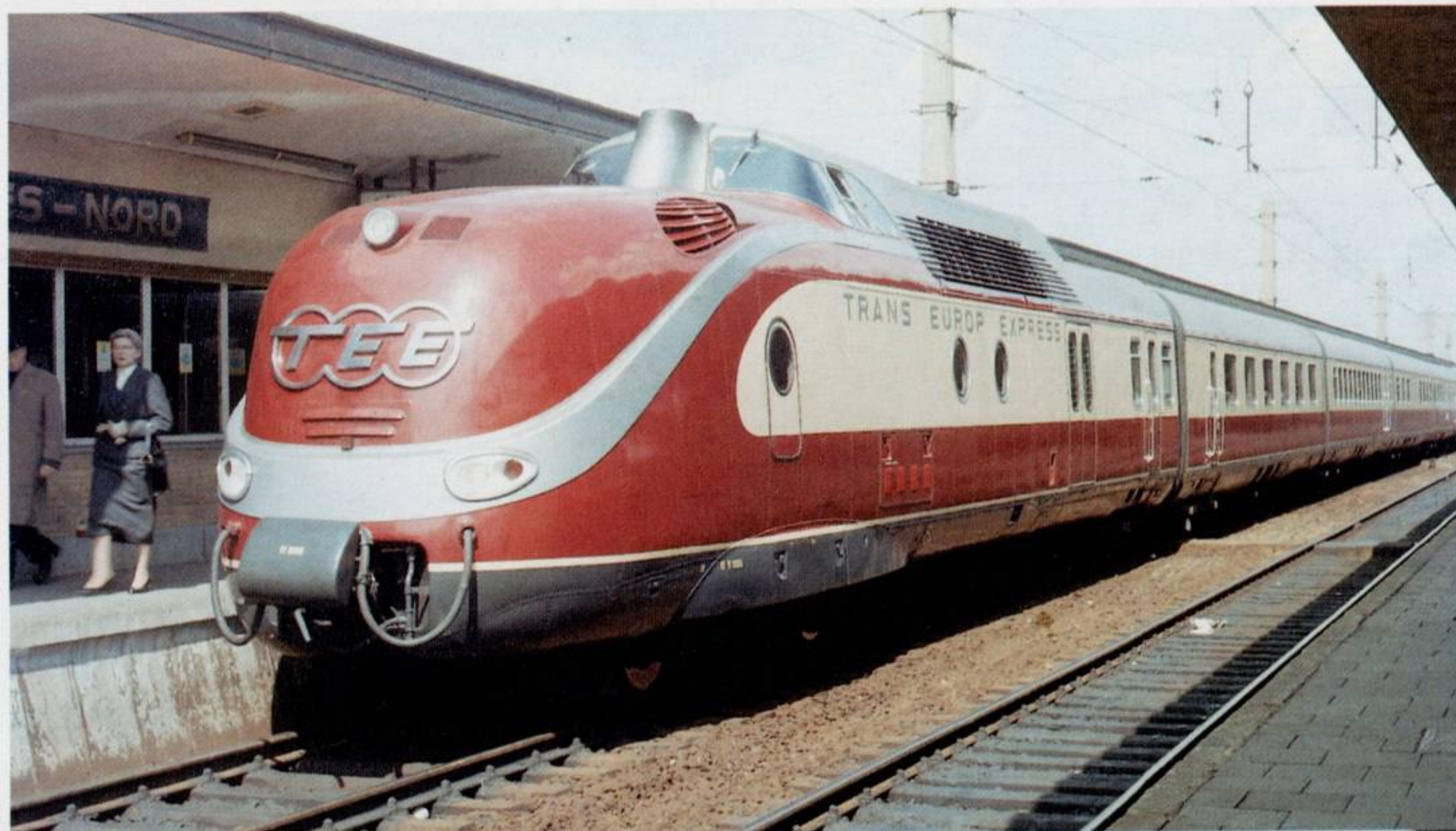
De eerste TEE's waren dieseltreinen, omdat ze op diverse netten moesten kunnen rijden. Dat deed geenszins afbreuk aan het comfort van de treinen.
